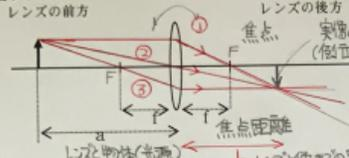
① 光軸に平行な光線は屈折後焦点を通る。
